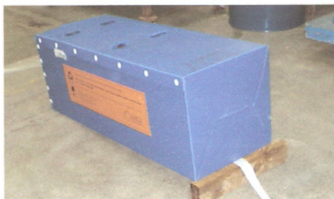
Foto 4 – Ensaio de queda rotacional
