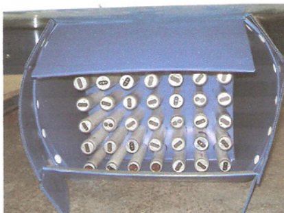
Foto 9 - Abertura da tampa sob compressão
