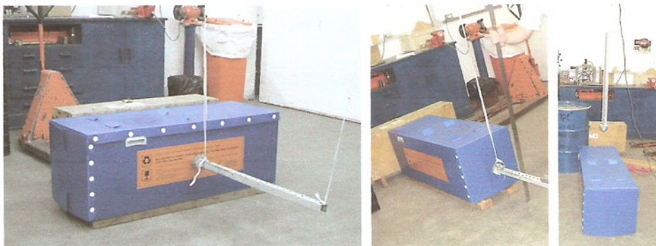
Fotos 6 a 8 – Três das cinco posições de impacto do dardo
